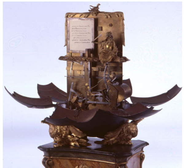
Abb. 2. Alleschreibende Wundermaschine (1760). Das Steuerwerk dieses Handschriftautomaten von Wolfgang Knaus befindet sich in der (hier geöffneten) Weltkugel. Die kleine Messingfigur (oben) ist mit einer Schreibfeder ausgestattet (© Technisches Museum Wien).
