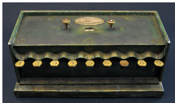
Schwilgué-Tastenaddiermaschine aus Strassburg. Eine äusserst seltene Addiermaschine aus dem Jahr 1851 von Jean-Baptiste Schwilgué, dem berühmten Uhrmacher aus Strassburg (Schöpfer der letzten astronomischen Uhr des Strassburger Münsters). Die meisten führenden technisch-wissenschaftlichen Museen hatten bisher keine Kenntnis vom Schwilguéschen Gerät. Aufgetaucht in der Kulturgütersammlung der ETH Zürich am 28. Januar 2014. © Herbert Spühler, Stallikon
