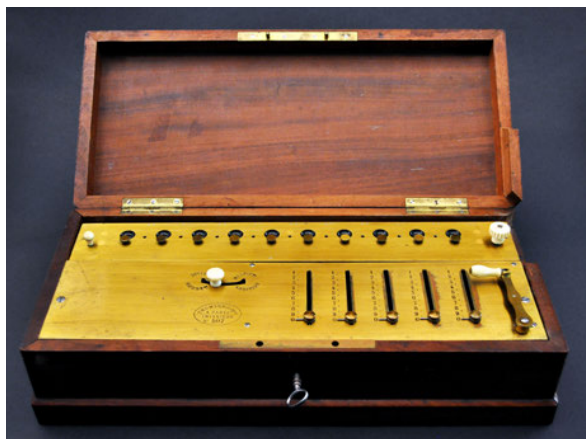
Thomas-Arithmometer aus Paris. Ein Meilenstein in der Geschichte der Rechentechnik: Das am 28. Januar 2014 in der Kulturgütersammlung der ETH Zürich (wieder) gefundene 150-jährige Thomas-Arithmometer, eine Vierspezies-Staffelwalzenmaschine aus Messing und Holz. © Herbert Spühler, Stallikon
