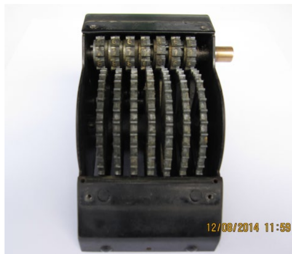
Abbildung 4. Ein Blick ins Innere des Volksrechners zeigt die Zahnräder des Einstellwerks (unten) und des Ergebniswerks (oben). © Bruderer Informatik, CH-9401 Rorschach 2014
