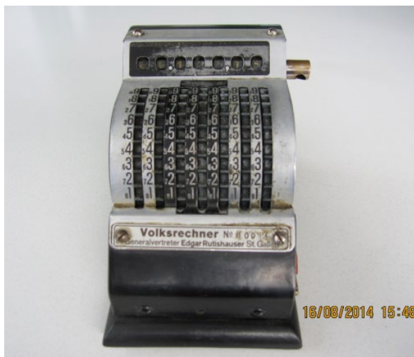
Abbildung 1. Stellradgriffeladdierer mit Subtraktion und automatischem Zehnerübertrag namens «Volksrechner» aus St. Gallen bzw. Berlin aus den 1930er Jahren. Bei der Löschkurbel fehlt der Griff. Zu beachten: Die grossen Ziffern dienen für die Addition, die kleinen Ziffern (Komplementärwerte) für die Subtraktion. © Bruderer Informatik, CH-9401 Rorschach 2014
