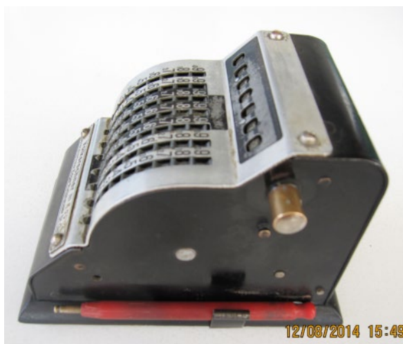
Abbildung 2. Volksrechner. Seitenansicht mit Stift für das Zahnradgetriebe (Eingabe der Zahlen) und Löschkurbel fürs Ergebniswerk (Griff fehlt). © Bruderer Informatik, CH-9401 Rorschach 2014
