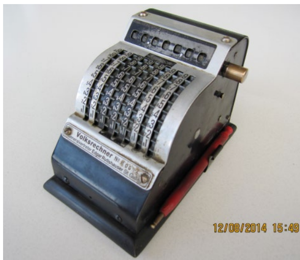
Abbildung 3. Der Volksrechner mit Einstellwerk (unten) und Eingabestift sowie Ergebniswerk (oben) mit Löschkurbel (ohne Griff). © Bruderer Informatik, CH-9401 Rorschach 2014
