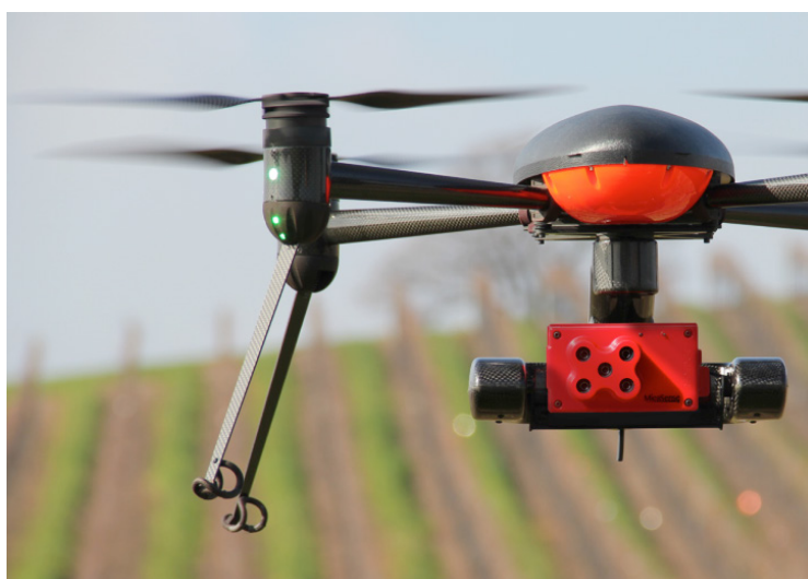
Drohne mit Hyperspektralkamera zur Früherkennung von pilzlichen Erkrankungen von Reben. Bild: ZHAW
